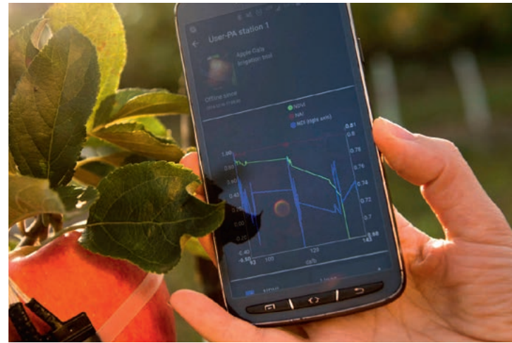
Der kleine „Rucksack“ ist ein Sensor. Er misst, in welchem Zustand der Apfel ist. Die Ergebnisse lassen sich dann auf einem Smartphone auswerten.
