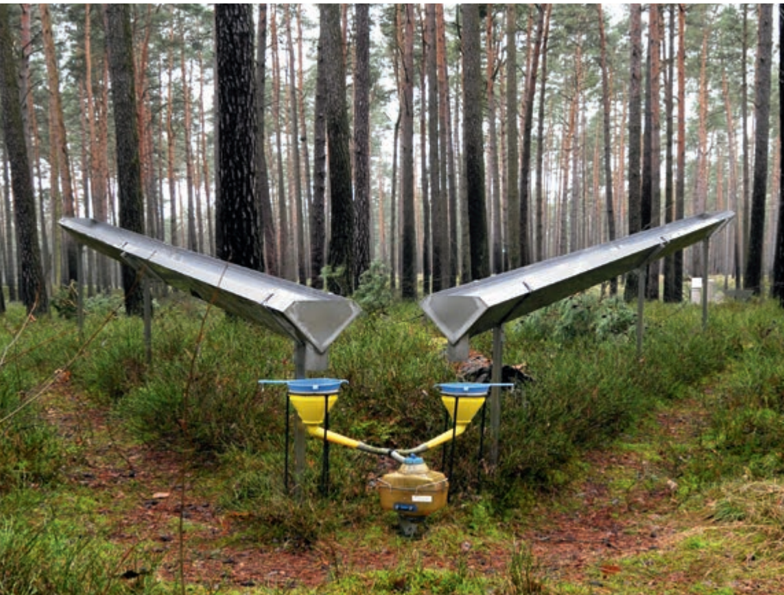
In langen Rinnen wird Regenwasser gesammelt, um die Niederschlagsmenge zu messen.
