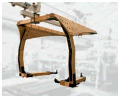
Durch Holz kann beim Bau industrieller Produktionsanlagen jede Menge Gewicht gespart werden.
