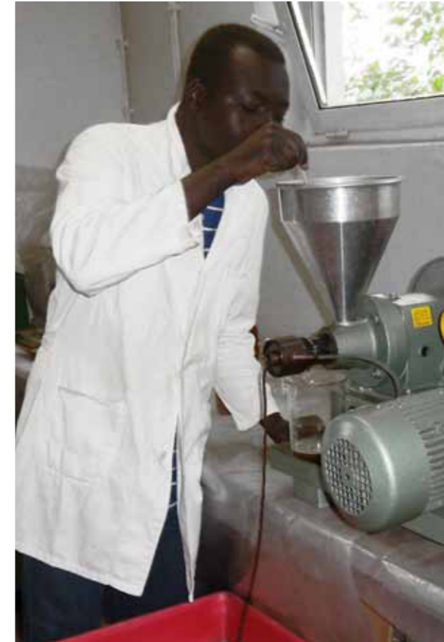
Abbildung 4: Gewinnung von Öl aus unterschiedlich getrockneten Niemsamen. Der ausgepresste Rückstand der Samen (Expeller) enthält noch insektizide Eigenschaften und wurde erfolgreich gegen den Befall von Kartoffelpflanzen mit dem Kartoffelkäfer ( Leptinotarsa decemlineata ) eingesetzt. Ein Azadirachtin-Produkt ist unter dem Namen Neem-Azal auch zur Bekämpfung dieses Schädlings in Deutschland zugelassen.
