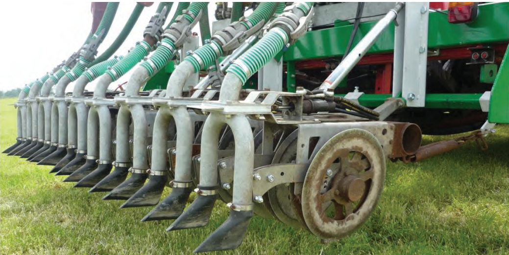
Abbildung 6: Gülleinjektionsgerät für die streifenförmige Injektion flüssiger Wirtschaftsdünger. Die Injektionsschlitze werden nicht verschlossen: Eine Applikationstechnik mit sehr geringer \text{NH}_3 -Emission, aber wie hoch sind die \text{N}_2\text{O} -Emissionen? (Foto: A. Pacholski)
