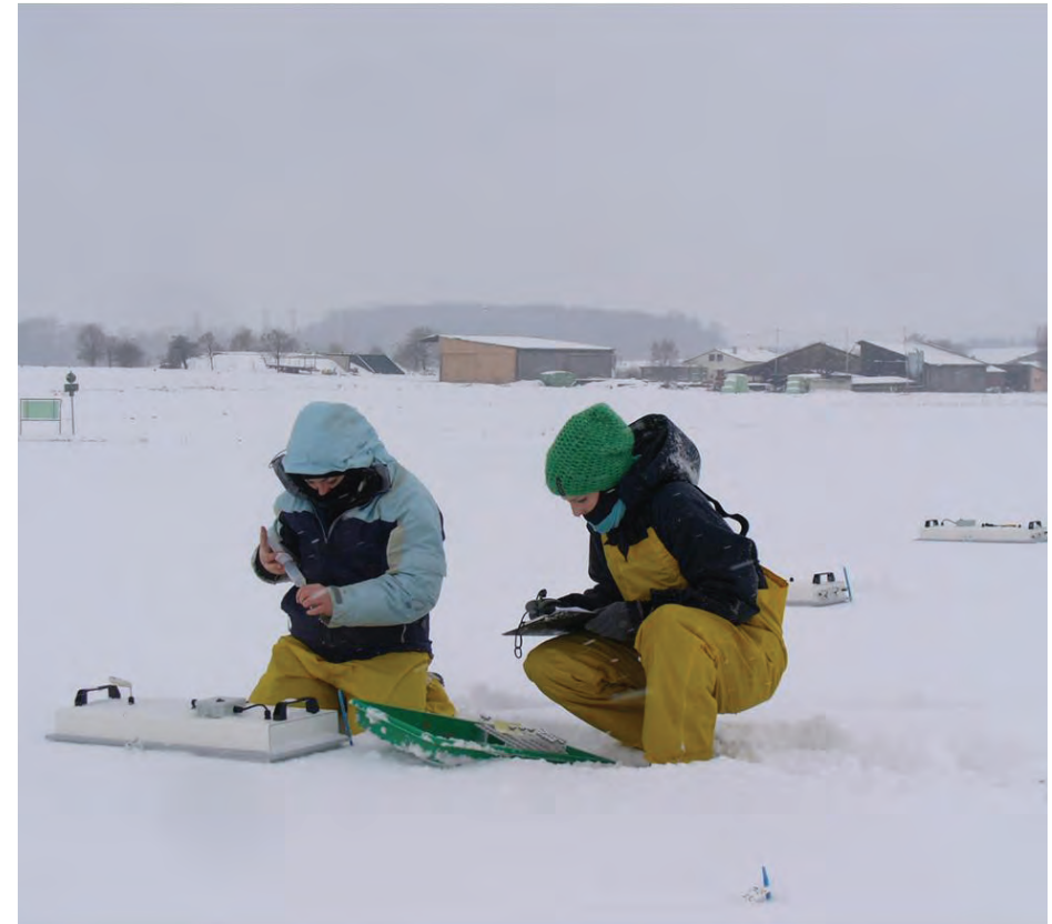
Abbildung 14: Erfassung der N_2O -Emission im Winter auf Versuchsflächen der Universität Hohenheim mittels installierter Bodenhauben, in denen sich das aus dem Boden emittierende N_2O anreichert. Die Gasprobenahme aus den Hauben erfolgt manuell mit einer Spitze (Foto: K. Kesenheimer)
