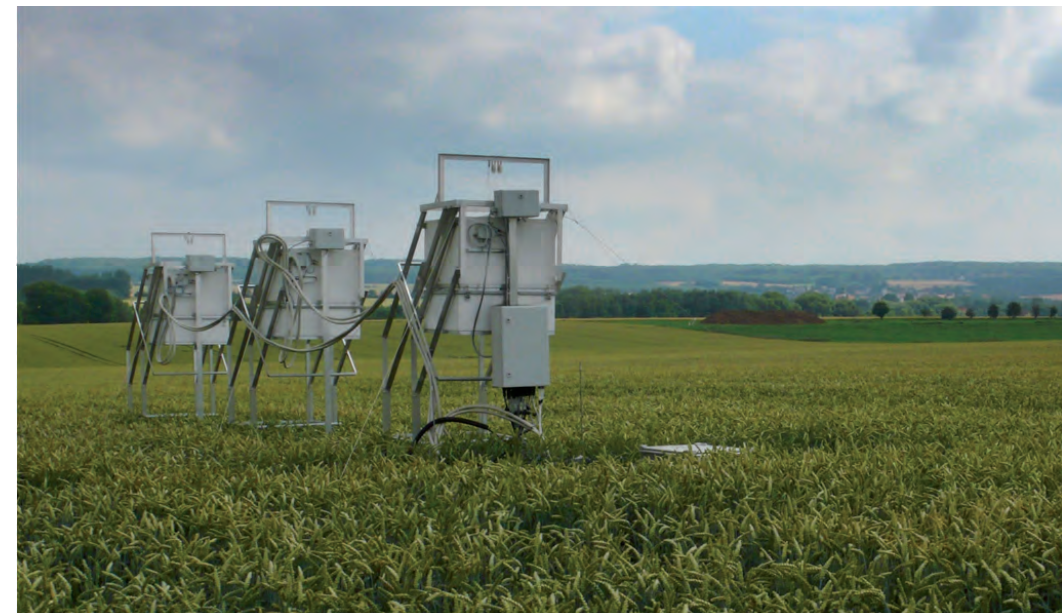
Abbildung 2: Erfassung der N_2O -Emission in einem Weizenfeld bei Buttstedt (Thüringen) mit Hilfe eines automatisierten Kammer- und Gasprobenahmesystems (Foto: D. Lempio)
