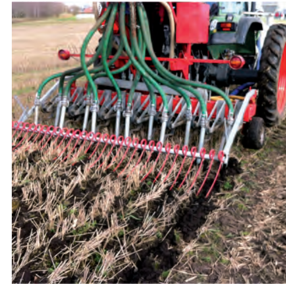
Abbildung 8: Gülleinjektion mit Verschluss der Injektionsschlitzte: Eine Applikationstechnik mit minimaler NH_3 -Emission, aber wie hoch sind die N_2O -Emissionen? (Foto: A. Pacholski)
