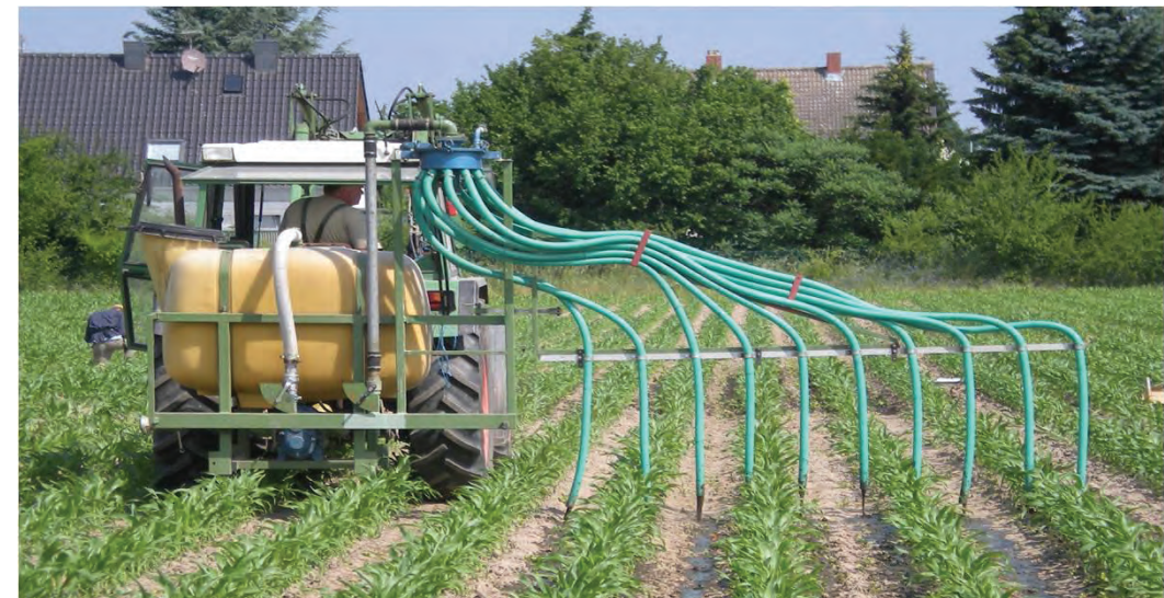
Abbildung 13: Ausbringung von Maisgärresten in einem Mais-Parzellenversuch in Braunschweig zur Quantifizierung der Wirkung des Nitrifikationshemmstoffs DCD auf die Emission von N_2O und NH_3 (Foto: U. Wolf)
