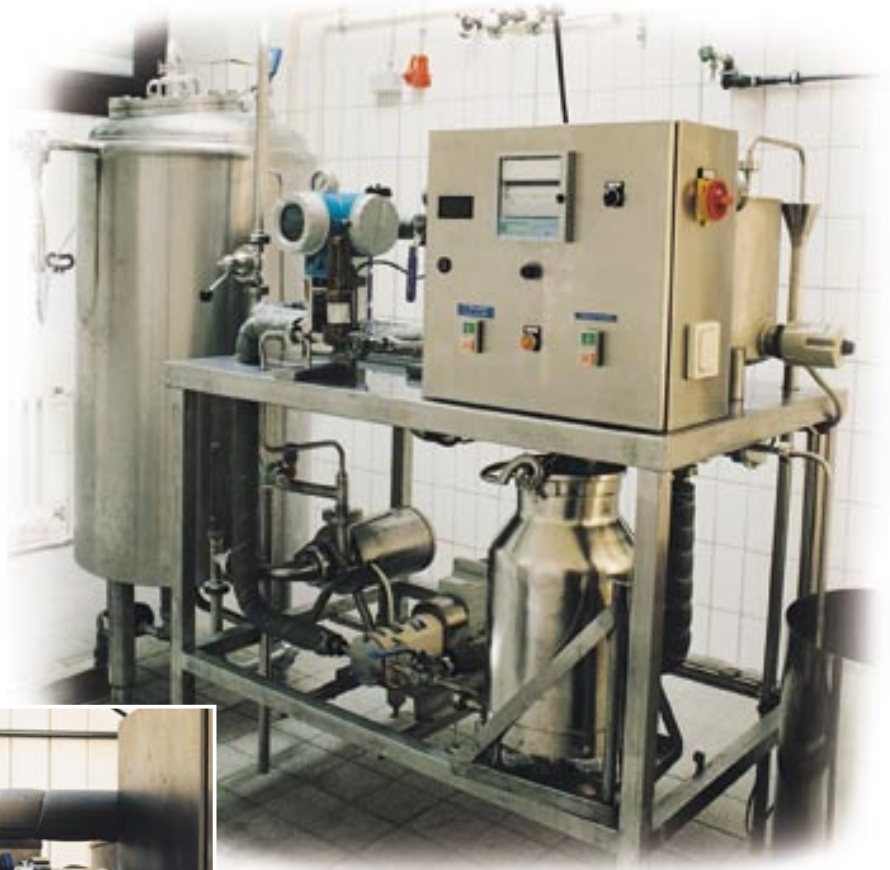
Abb. 3: Laboranlage zur experimentellen Kurzzeiterhitzung von Milch (Übersicht und Ausschnitt; Fotos: I. Spreckels, BAFM Kiel)
